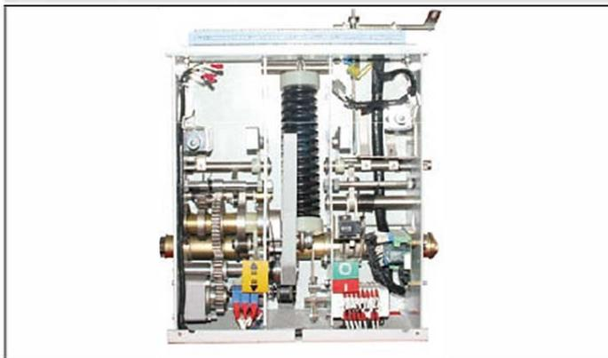
пружинный привод -VS1
